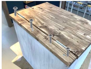
ビスを打つ箇所に印をして、下穴をあけてからビス止めします。
