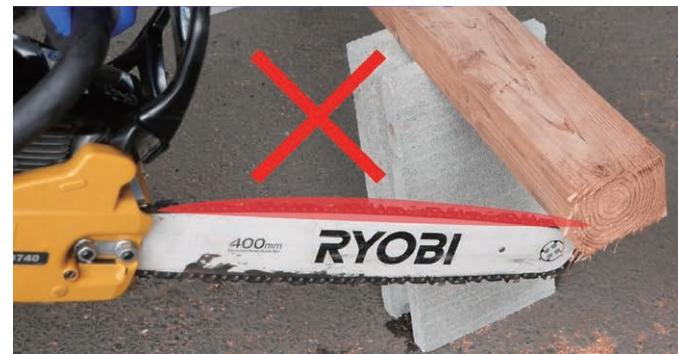
ガイドバーの先端部上側だけでは切らないこと。また、バーの先端が切断中の木材の陰にある小丸太などに触れないよう注意します。ガイドバーの先端部上側の円周部分がキックバックを起こしやすい箇所です。
