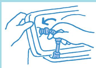
手洗い付きタンクのふたを開けるのは、手洗い管をジャバラ管から外してから。ふたを起こして2つの管の接続部分を左に回しながら引っ張れば外れます。
