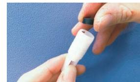
ピストンバルブの先に付いている弁パッキンを、マイナスドライバーなどでこじ開けて外し、新しいパッキンをはめ込みます。
