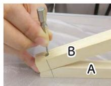
② 工作材Bに穴をあけます。その後ドライバーなどの先のとがった物を使って、工作材Bにあけた穴の中心から工作材Aに向かってさして、工作材Aの穴あけ位置を決めます。
