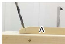
③ ①で引いた線の角度を保ち、斜め方向に電動ドリルドライバーで穴をあけていきます。
