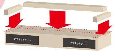
**STEP 2** 土台になる木材に割りばしで囲いをできるように木工用接着剤で取り付けます。
