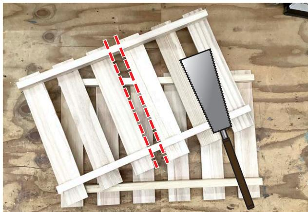
② 半分に切断したすのこの、短い板の端を切り落とします。
